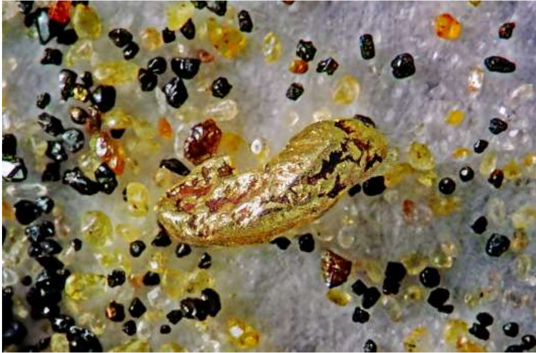
Grain d'or, 0,8 mm, cassitérite, grains rouge foncé, hématite ou ilménite, grains noirs, monazite, cristaux jaunes de 0,1mm, zircons incolores et un grenat rouge clair, en haut de l'image, la Loire, Ouzouer-sur-Loire, Loiret
