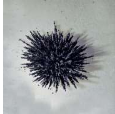
Magnétite, (grains < 0,5 mm) au contact avec un aimant ferrite,
